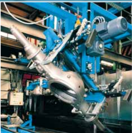
Specjalne urządzenie turbinowe do strumieniowania osi samochodów ciężarowych
