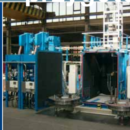
Sterowana numerycznie 3-osiowa dwutaktowa pneumatyczna maszyna stołowa do utwardzania (shot peeningu)
