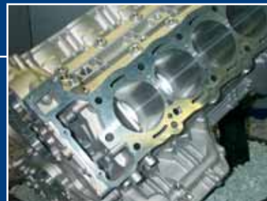
Korpus silnika samochodowego, oczyszczony po odlaniu
