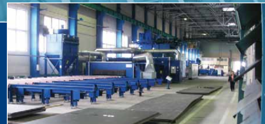
Linia do konserwacji blach i profili, szerokość robocza 3000mm
