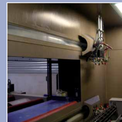
Manipulator z pistoletami – widok wnętrza kabiny malarskiej
