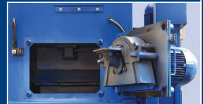
Zespół turbiny rzutowej na drzwiach uchylnych
