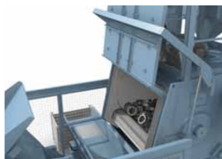
Hydrauliczny załadunek, wyładunek za pomocą przenośnika wibracyjnego
