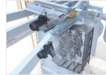
Komora śrutownicza z okładzinami odpornymi na ścieranie
