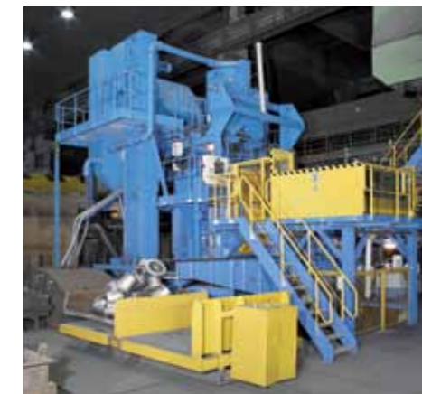
Instalacje do prac ciężkich z automatycznym załadunkiem/rozładunkiem
