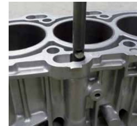
Wewnętrzne oczyszczanie skrzyni korbowej
