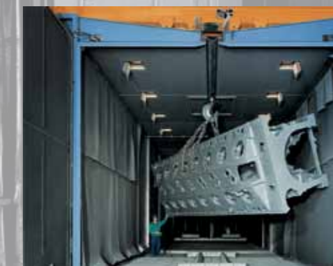
Komora śrutownicza do obróbki 80-tonowego bloku silnika diesla
